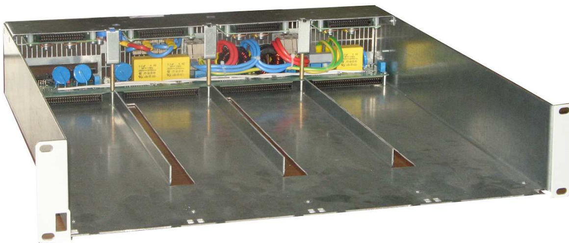
Рисунок 1.1 – Модульный каркас PS2000K, ver.2. Вид с фронтальной стороны
