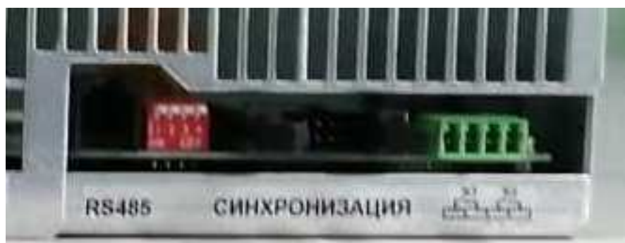
Рисунок 2.2 – Модульный каркас Штиль PS2000К, ver.2. Тыльная сторона. Вид на дип-переключатель настройки параллельной работы
